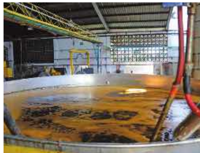
La melaza y el jugo de caña se dejan fermentar tres días en grandes cubas de metal antes de destilarse.
