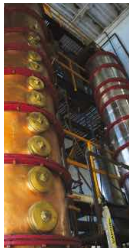
Alambiques para la doble destilación del sotol.
