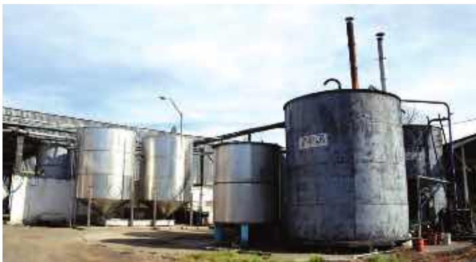
Alambique para la doble destilación de la charanda; luego se rebaja con agua.
