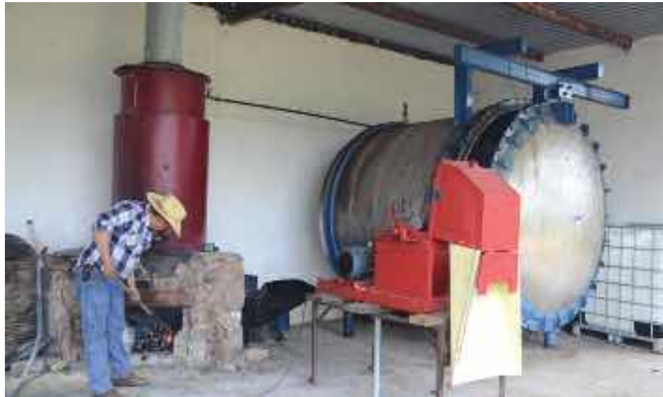
Se utilizan grandes botes metálicos para la destilación.
