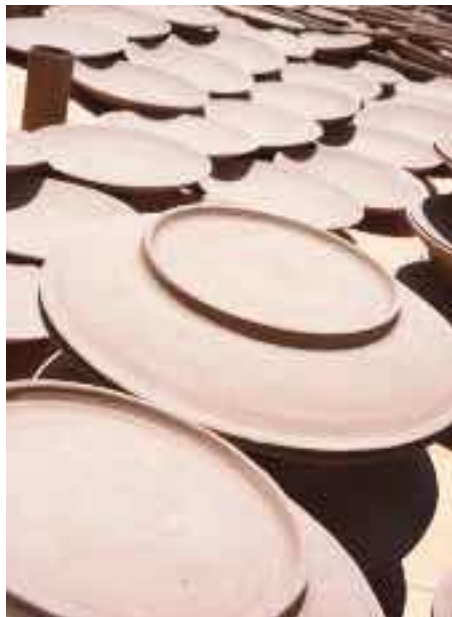
Los objetos moldeados o torneados se dejan secar antes de entrar por primera vez en el horno.
